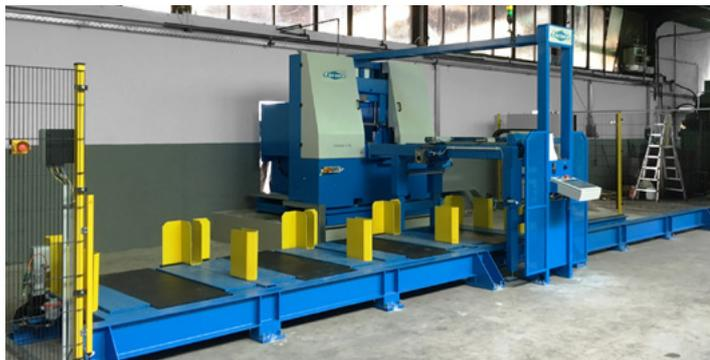
In den vergangenen Tagen war es soweit, unsere neue Bandsägeanlage ging in Betrieb. Sie verfügt über eine Zuführungseinrichtung und eine automatisierte Vereinzelungsanlage zur Sortierung von geschnittenem Vormaterial und Reststücken. Gesteuert wird die Anlage über eine Siemens S 7-1500. Aus der Investition ergeben sich für WSW zahl-
